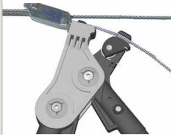
1. Tournez la molette jusqu'à la tension désirée. Écartez complètement les poignées, et tirez d'un mouvement sec pour ouvrir la came et agripper le câble.
